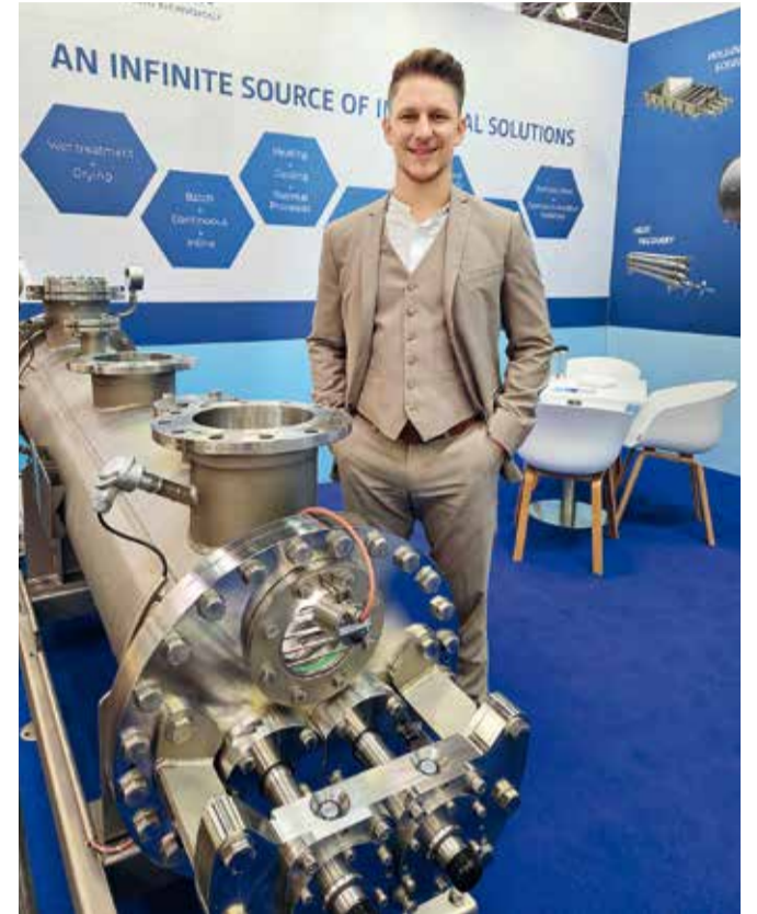
„Unser Schneckenreaktor eignet sich für die Nass- und Trockenbehandlung von Kunststoffen“, erläutert Till Hönicke.
